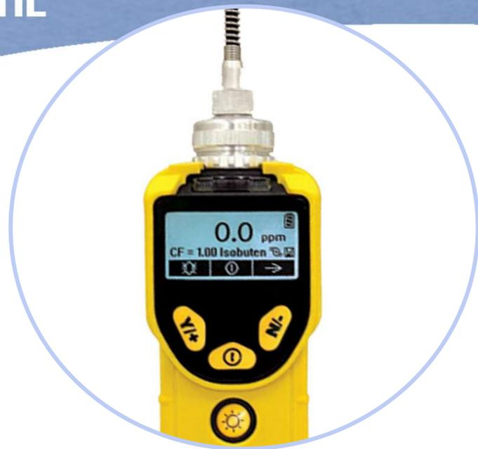
» É o mais avançado detector de composto orgânico volátil (VOC\*) do mercado. O tempo de resposta de 3 segundos e intervalo estendido de 0 a 15.000 ppm do seu detector de fotoionização (PID) o torna imprescindível na leitura dos VOCs\*.
