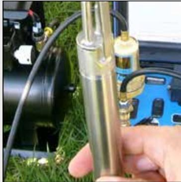
**4.** Conecte o tubo de descarga da amostra à saída de produto da bomba (acesso de menor comprimento localizado na parte superior do equipamento) e a extremidade oposta à entrada da célula de fluxo.
