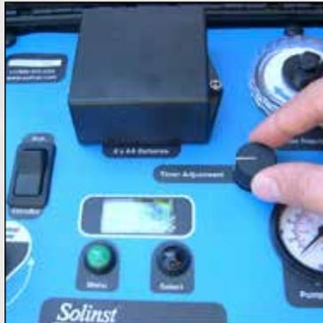
15. Na unidade controladora, altere a chave de partida da posição "Standby" para "Run" para iniciar o bombeamento.
