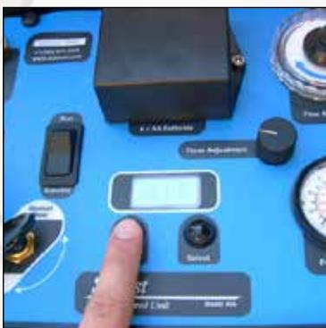
13. Caso o ciclo de carga e descarga não for satisfatório, ajuste o tempo de injeção de ar na bomba "Drive", pressione "Select" e gire o potenciômetro "Timer Adjustment".
