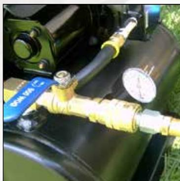
**2.** Conecte a segunda mangueira à saída de ar (Air Out) da Unidade Controladora e a extremidade oposta ao tubo que fornecerá ar à bomba.
